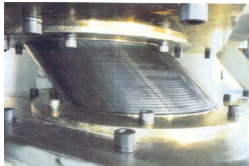
شکل ۷- جداگرهای لرزه ای در جهت افقی می توانند تا ۴۵ درجه حرکت کنند.
