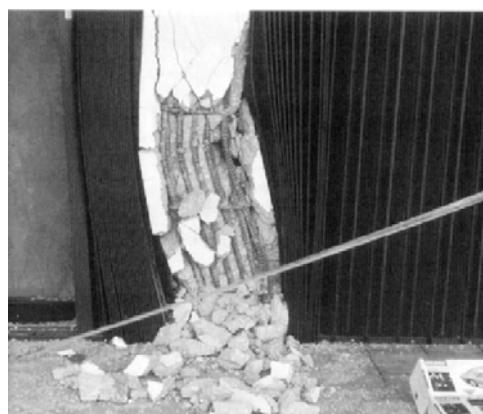
شکل ۱- جذب انرژی در هنگام زلزله با تغییر شکل های دائمی و غیر قابل بازگشت در عناصر سازه ای همراه است.
