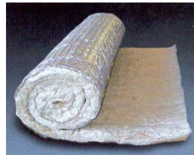
SE3: پسا ایزوبلانکت پشم خام فله ای است که به صورت رول لحافی می باشد . از یک طرف به تور سیمی گالوانیزه و یک لایه فویل آلومینیوم دوخته شده است .
