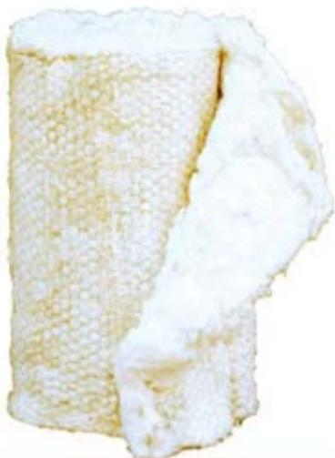
وقتی فلت الیاف نیافته شیشه با یک ورق توری گالوانیزه همراه میشود محصولی با نام 600 W حاصل می آید این محصول برای عایق کاری جداره های ظروف صنعتی منجمله جداره دیگهای بخار و لوله های انتقال سیال تا دمای ۵۵۰ درجه سانتیگراد کاربرد دارد.
